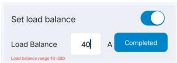
Corrente di ricarica = 40A - corrente di carico domestico ( $6A \leq$  corrente di ricarica della colonnina di ricarica EV  $\leq 32A$ ).
