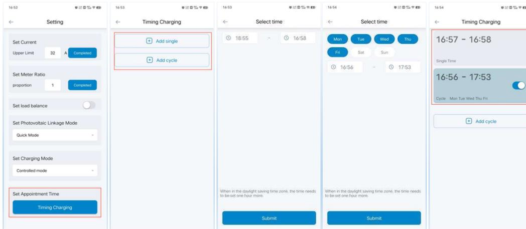
**Nota:** Per la ricarica programmata, è possibile impostare solo l'orario di ricarica programmata in stato di stand-by in modalità controllata.
