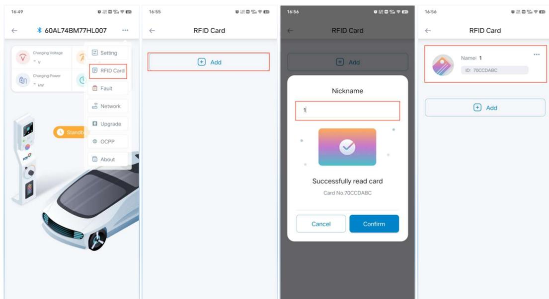
**Nota:** La colonnina di ricarica EV è fornito con due carte RFID, e puoi aggiungere al massimo 8 carte RFID a una colonnina di ricarica EV.
