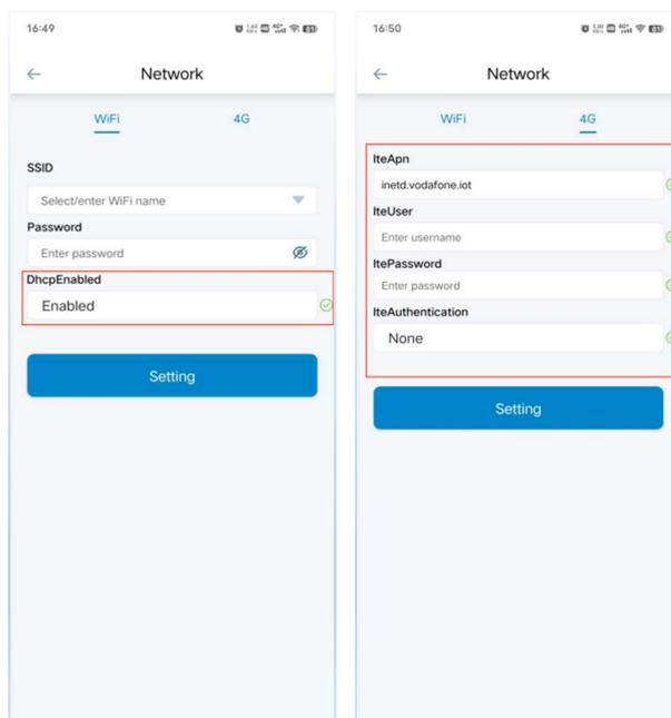
**Nota:** Per garantire la stabilità della configurazione di rete, si consiglia di spegnere l'alimentazione e riavviare la colonnina di ricarica EV dopo la configurazione di rete. Puoi connetterti alla rete e accedere al Cloud entro 3 minuti dopo il riavvio. In modalità Cloud, l'intervallo di caricamento dei dati di ricarica della
